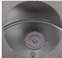
Lampada UV LED battericida nel serbatoio
